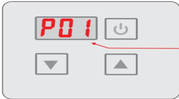
TEMPERATURA DE ENTRADA DEL AGUA. FALLA DE SENSOR
