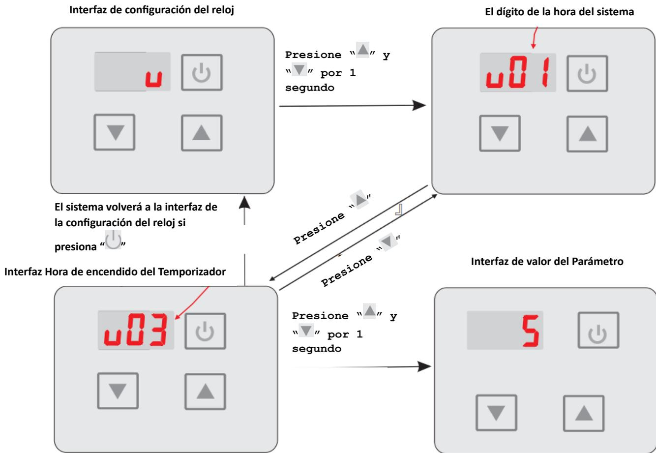
En la "Interfaz hora de encendido del Temporizador" presione "▲" o "▼" para visualizar circularmente entre temporización v03, v04, v05, v06, v07 y v08, luego presione "▲" y "▼" para entrar a la "Interfaz de valor del Parámetro", a continuación, presione "▲" o "▼" para cambiar el valor.
