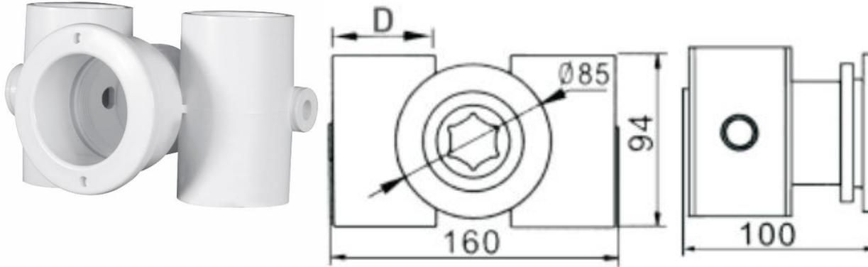
Las boquillas de hidromasaje de la serie SP se puede instalar en una piscina de concreto o en fibra de vidrio. El exclusivo sistema de inyección aire de estos dispositivos asegura una distribución perfecta de micro burbujas de aire en el chorro de agua; así mismo el terminal de salida es dirigible y puede orientar el efecto en un rango de direcciones hacia la piscina.
