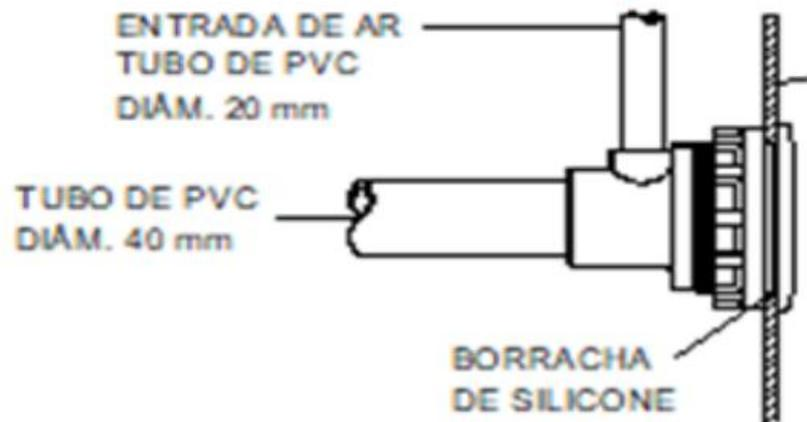
La toma de aire debe estar ubicada por arriba del nivel del agua y el piso circundante y no ubicada en el propio piso. Puede estar hasta 4 metros de distancia y preferiblemente en una ubicación protegida y dotada de barreras que puedan evitar la entrada de insectos y otros objetos. La válvula de aire debe ser pegada en la parte libre del tubo de 20mm utilizado para la toma de aire externo.
