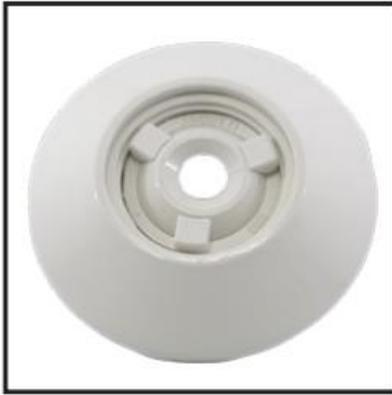
Los dispositivos de retorno de la serie DR son para piscinas de concreto. El cuerpo La base esta hecha de material termoplástico blanco (ABS). Tienen rosca BSP de 1 1/2", destinadas a la conexión del anillo elástico del ojo de buey. El jet es orientable con un ángulo máximo de 25° en relación a al centro, a través de una esfera direccional (ojo de buey).
