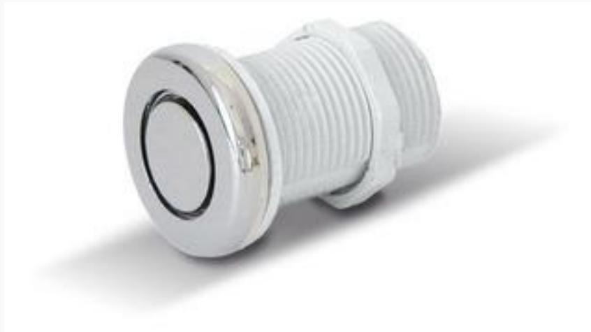
El pulsador neumático, también conocido como botón de aire o pulsador neumático, es un sistema de encendido que trabaja enviando una señal de arranque a través de la conducción de aire desde el mismo hacia la electrobomba, este encendido se logra gracias a una manguera que lo une a un switch neumático y a la electrobomba.
